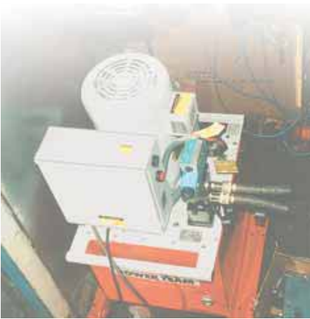
Bomba PE4004S y cilindro RD3006 usados en una prensa especial que repara eslabones de cadena dañados para la industria naval.
