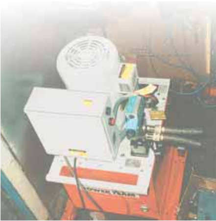
Bomba PE4004S y cilindro RD3006 usados en una prensa especial que repara eslabones de cadena dañados para la industria naval.
