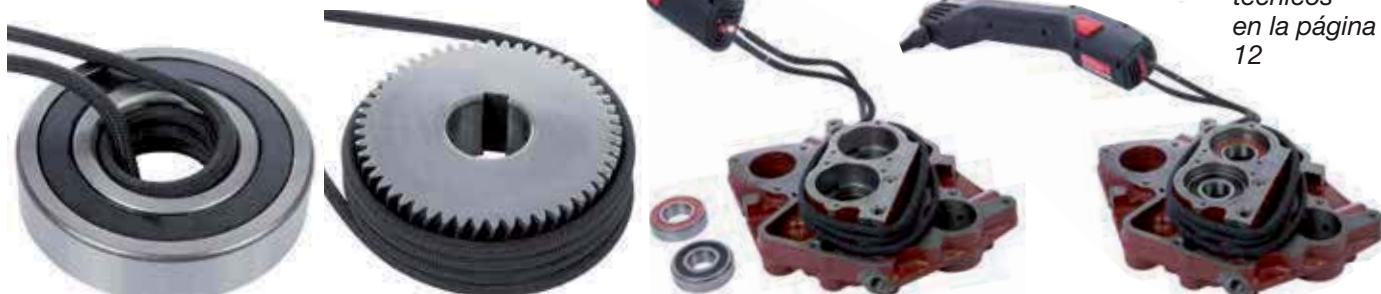
Inductor flexible para calentar distintos tipos de piezas
