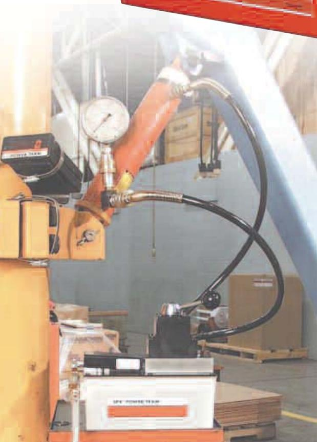
Bomba PA6D, manómetro digital DG100 y cilindro de 25 toneladas usadas en un montaje de prueba.
