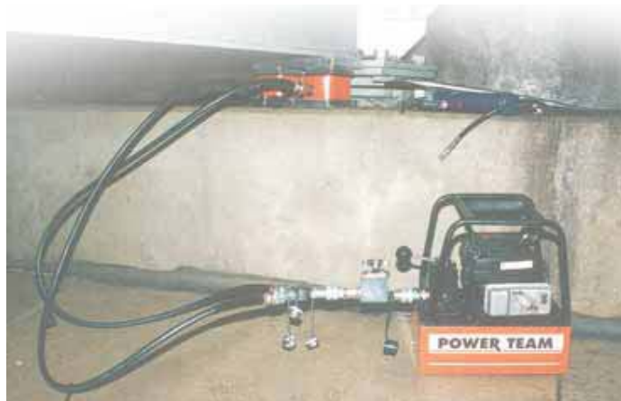
Las bombas hidráulicas alimentadas por gasolina como esta PG303 generan fuerza hidráulica en lugares remotos.
