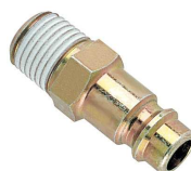
IB11NMC4 25014036 Conector Serie IBN/IBS, conexión macho 1/2", paso 11 mm (ISO6150B / MIL-C4109)
