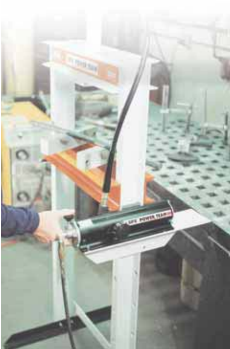
Bomba PA9H con control manual usada en una prensa de enderezamiento.
