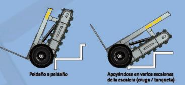
El SR Express es de fácil manejo y puede utilizario una sola persona. Este aparato tiene varias funciones y opciones tales como: ajuste de altura del maneral, cambio rapido de la batería, manejo a distancia, plataforma de altura regulable y diferentes tipos de ruedas.
