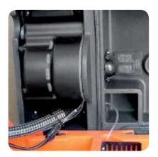
Depósito agua de recuperación con inspección visual.
